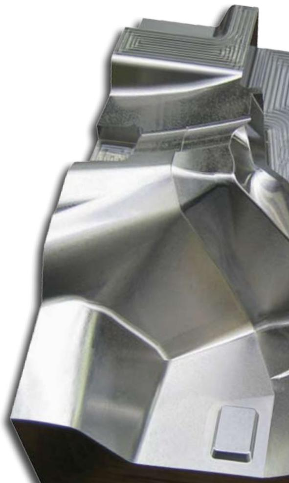
I percorsi generati da VISI sono ottimizzati per ridurre il numero delle ritrazioni, per mantenere costante il carico sull'utensile, per minimizzare le brusche variazioni di direzione e di velocità, per evitare di affondare l'utensile nel materiale in eccesso, per distribuire uniformemente i punti e per eliminare le collisioni.
